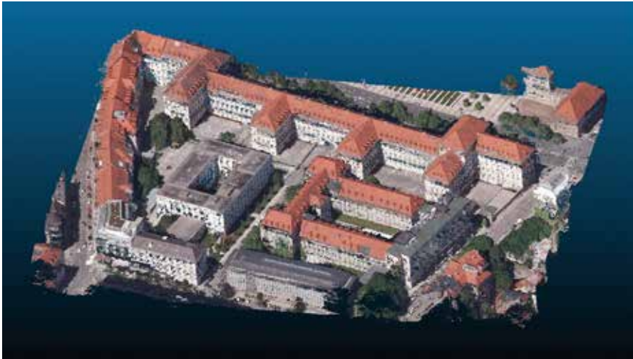
Abb. 3: Farbkodierte 3D-Punktvolke des Landesamtes für Vermessung und Geoinformation (LVG)
