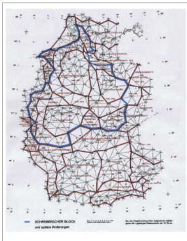
Bild 1: Das deutsche Hauptdreiecksnetz (DHDN)
