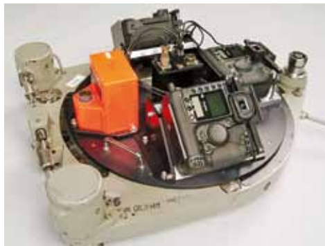
Bild 4: Plattform mit 3K-Kamera und IMU-Einheit. Quelle: [Kurz 2009], Institut für Methodik der Fernerkundung (IMF), DLR
