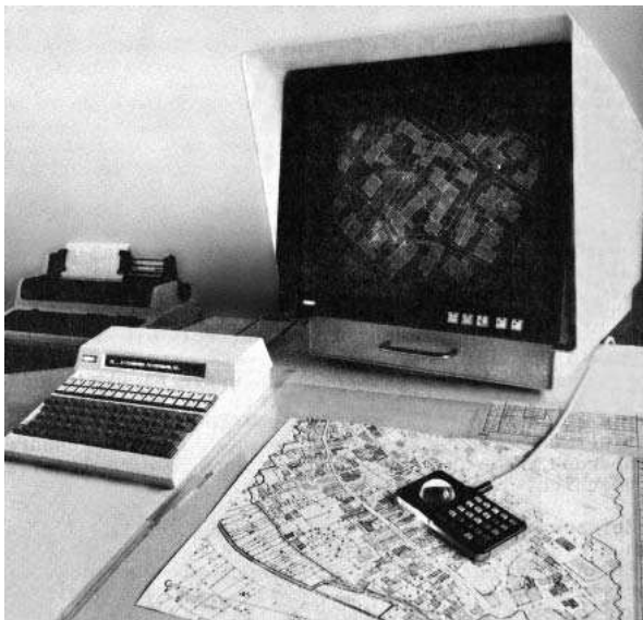
Bild 8: Interaktives, graphisches Erfassungssystem Aristogrid CD 400
