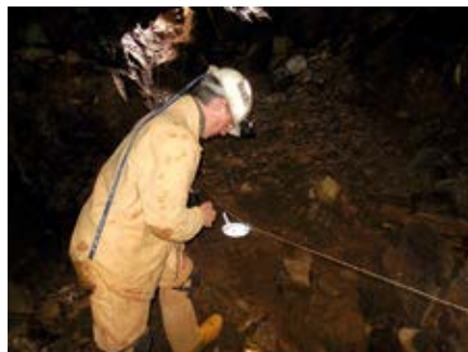
Abbildung 9: Marcus Wandinger am Hängezeug bei der Vermessung eines alten Grubenbaus am Schneeberg. Foto: Jens Schröter
